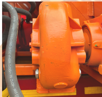
Редуктор привода транспортера с гидромотором
