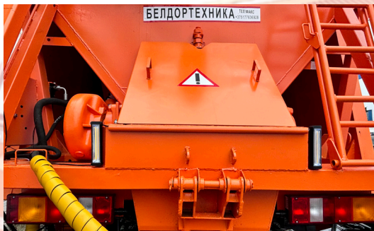
На бункере установлены стробоскопы
